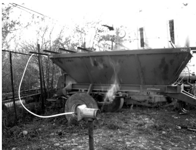
Рис.40. Факельная горелка для сжигания излишков биогаза в с. Петровка.
