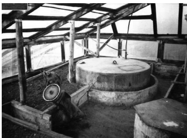
Рис.13. Установка с плавающим куполом в с.Садовом Литинского района, Винницкой области, Украина.
