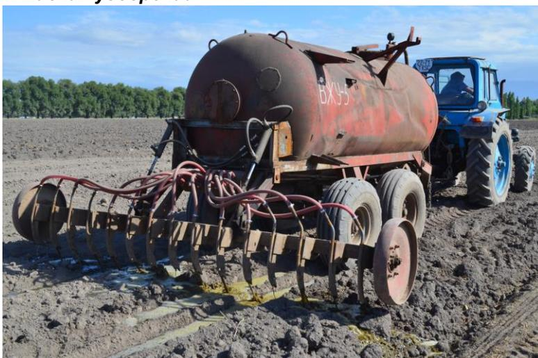
**Рис.75. Внесение через систему движущихся шлангов**
