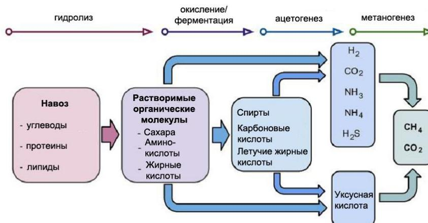
**Рис.14. Процесс производства биогаза**
