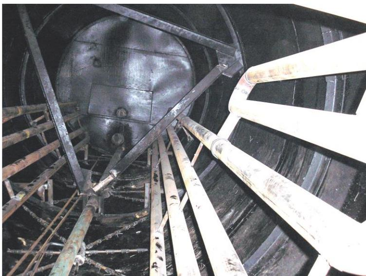
**Рис.45. Система подогрева и пневматического перемешивания сырья в реакторе**
