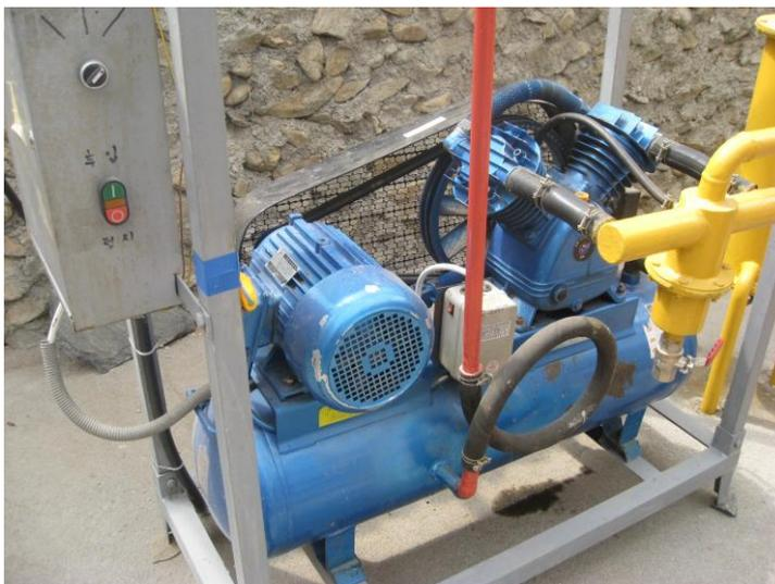
**Рис.40. Компрессор мощностью 4 кВт для пневматической загрузки сырья и отбора биогаза.**
