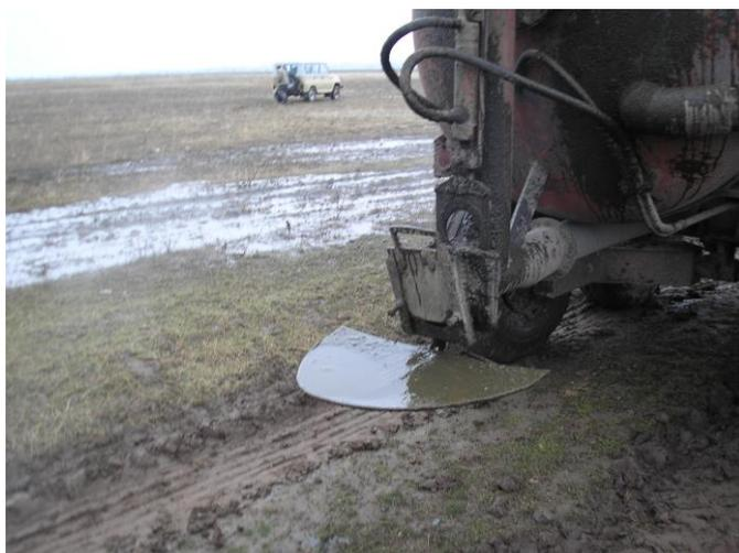
**Рис.73. Пластина для разбрызгивания
