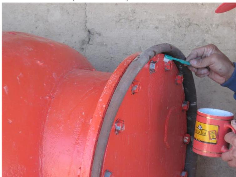
**Рис.50. Проверка герметичности газгольдера**
