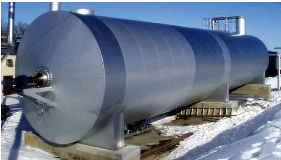
**Рис. 27. Горизонтальный реактор, Дания .**
